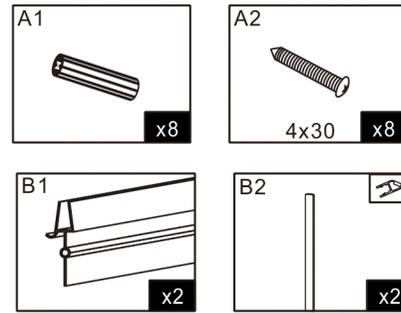
2. Bringen Sie das Magnetprofil (B2) an die Seiten des Glases an. Danach schieben Sie die Bodendichtung (B1) unterhalb des Glases rein. Schneiden Sie den Überschuss von der Bodendichtung ab.
